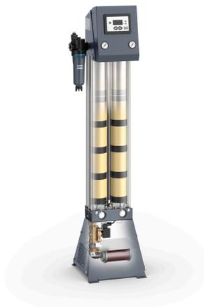
**Serie BD+ / BP+ ZP:** Secadores con regeneración por soplante, de alta eficiencia energética, ideales para altas demandas de aire y uso continuo en procesos importantes. Con monitorización y control avanzados para un secado de hasta  $-70^{\circ}\text{C}$  de punto de rocío.
