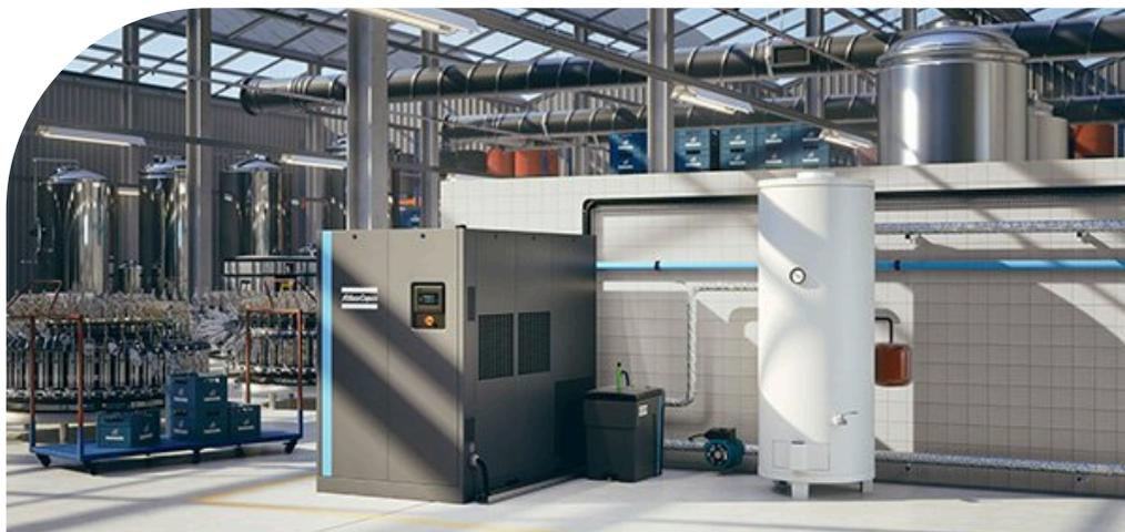
**Sistema de recuperación de energía integrado:** Toda la energía eléctrica consumida por un sistema de aire comprimido se convierte en calor. ¿Por qué dejar que se desperdicie ese calor? En los compresores de tornillo rotativo con inyección de aceite se puede instalar un **sistema de recuperación de energía que le permitiría recuperar hasta el 75% de esa potencia absorbida en forma de aire o agua calientes** (por ejemplo, para las duchas de los vestuarios).
